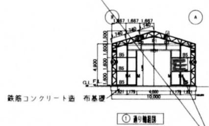
鉄筋コンクリート造 布基礎
