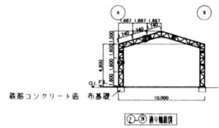
鉄筋コンクリート造 布基礎
